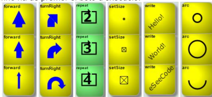
Figura 3: Les icones de la vista Mou s'adapten dependent del valor dels seus arguments
